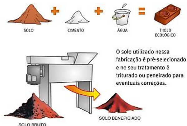
Figura 2: Componentes da mistura de solo-cimento Fonte: Sahara (2001) apud Oliveira (2020)
